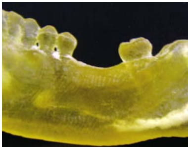
Foto 25: modelo estereolitográfico de resina.
