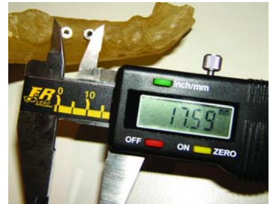
Foto 27: comprobando la fidelidad de las medidas en el modelo de resina.
